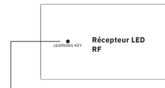
**Étape 2 :** Appuyez sur le bouton « Clé d'apprentissage » du récepteur RF ou redémarrez le récepteur trois fois consécutives pour l'activer en mode de couplage.
